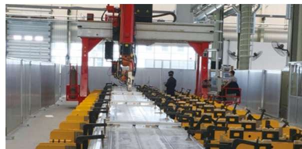
600公里磁悬浮车体激光焊接技术
